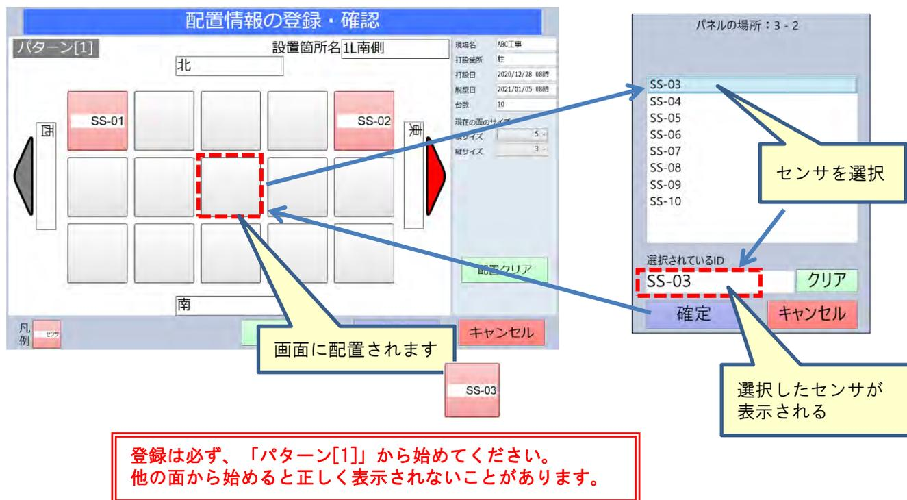
配置したセンサをクリアする場合は、クリアしたいマスを選択しセンサ選択画面で「クリア」します。
