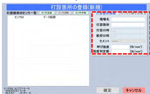
強度確認に必要な現場名、打設箇所、打設・脱型日時、セメント情報を入力します。
