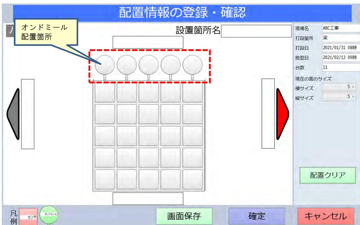
配置したいオンドミールのマスを選択すると、オンドミールの熱電対のチャンネル(ch1~ch4)選択画面が表示されます。チャンネルを選択して「確定」すると、そのマスにチャンネルが配置されます。
