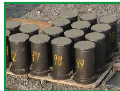
テストピースによる強度確認
