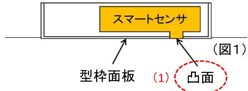
③.センサの凸面が型枠の面板と同一面となるように「高さ調整用ネジ」で調整してください。
