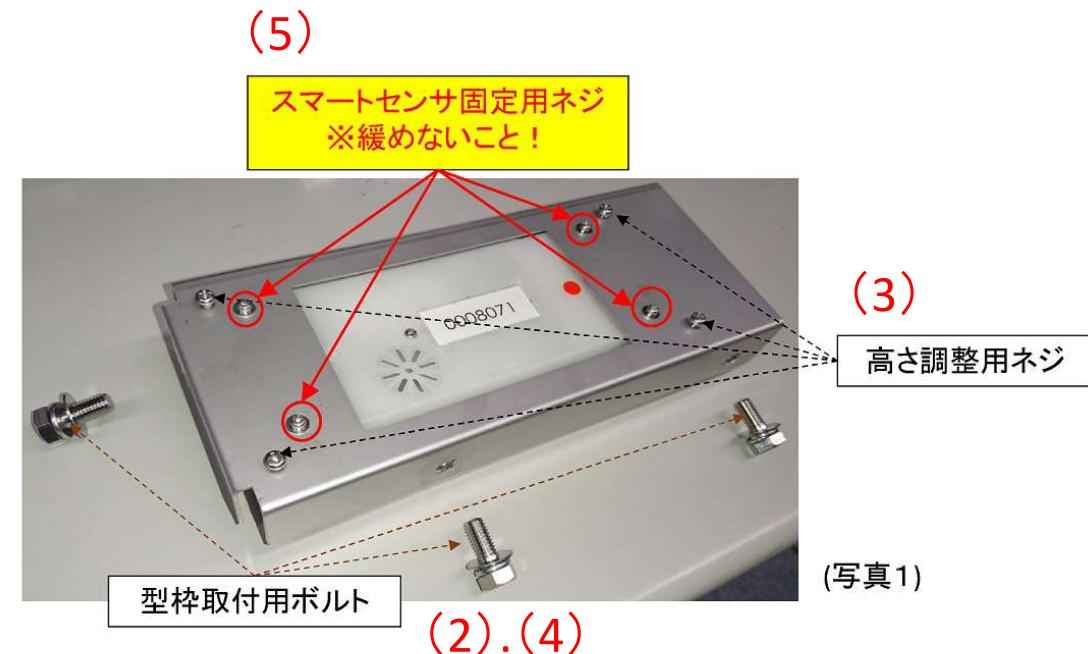
型枠面板と凸面が合う様に調整
