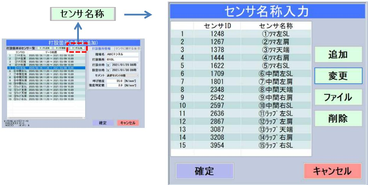
① センサを追加します。一覧にセンサが追加されます。操作は、p26 7) センサの追加 と同じです。
