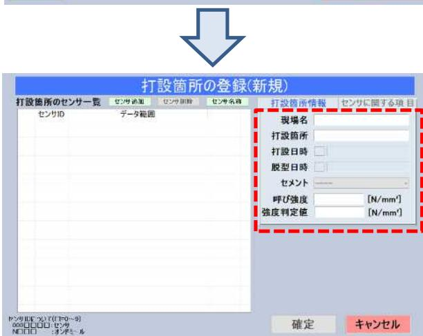
強度確認に必要な現場名、打設箇所、打設・脱型日時、セメント情報を入力します。
